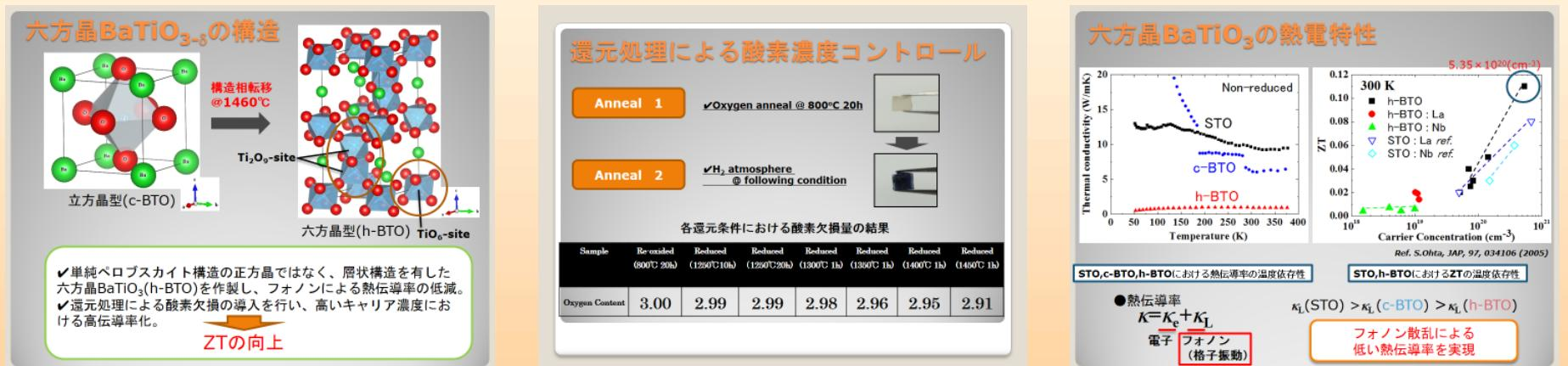
構造のチューニングにより熱伝導の低下を実現
